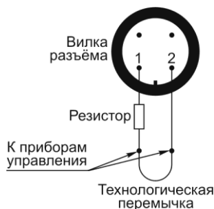
Рис. 5. Схема подключения МПП к линии пуска
