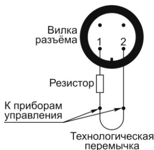
Рис. 5. Схема подключения МПП к линии пуска
