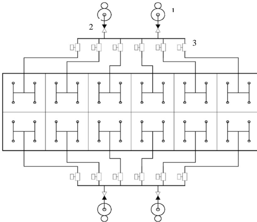
**Где:1-модуль; 2-обратный клапан;3-УЗП(устройство запорно-пусковое).**
