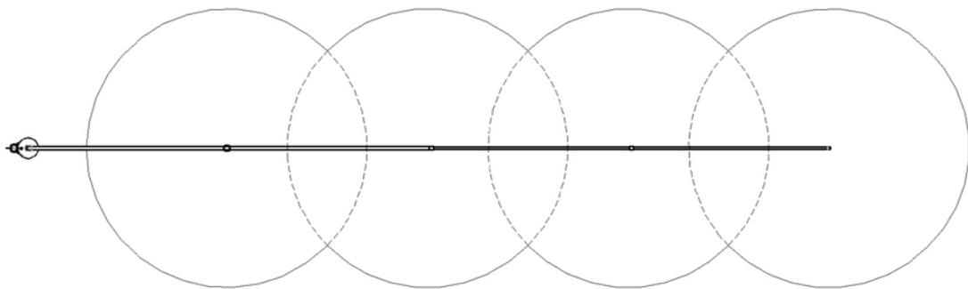
**Рис.И.8. Рекомендуемая схема разводки в одну линию.**
