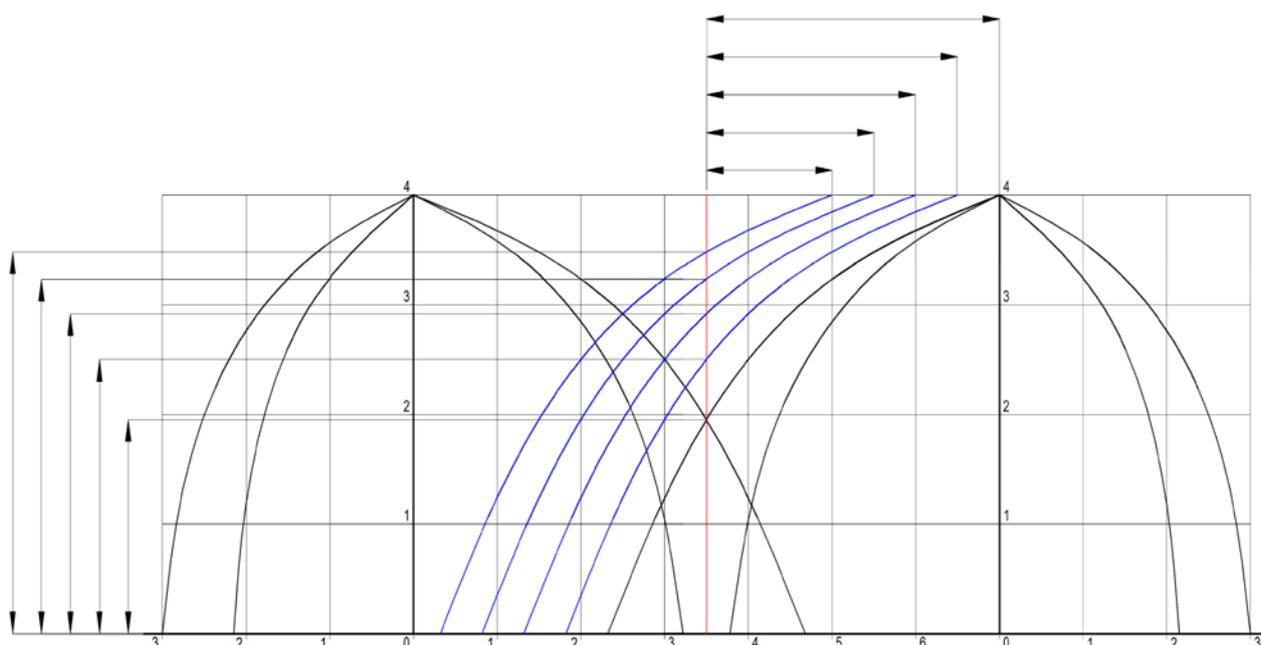
Рис.6.8 Зависимость расстояния между распылителями от высоты размещаемого в зоне распыла ТРВ защищаемого оборудования применительно к насадке НС-390С. Для насадка типа НС-360 следует использовать диаграмму распыления, представленную на рис.И.5 Приложения И.
