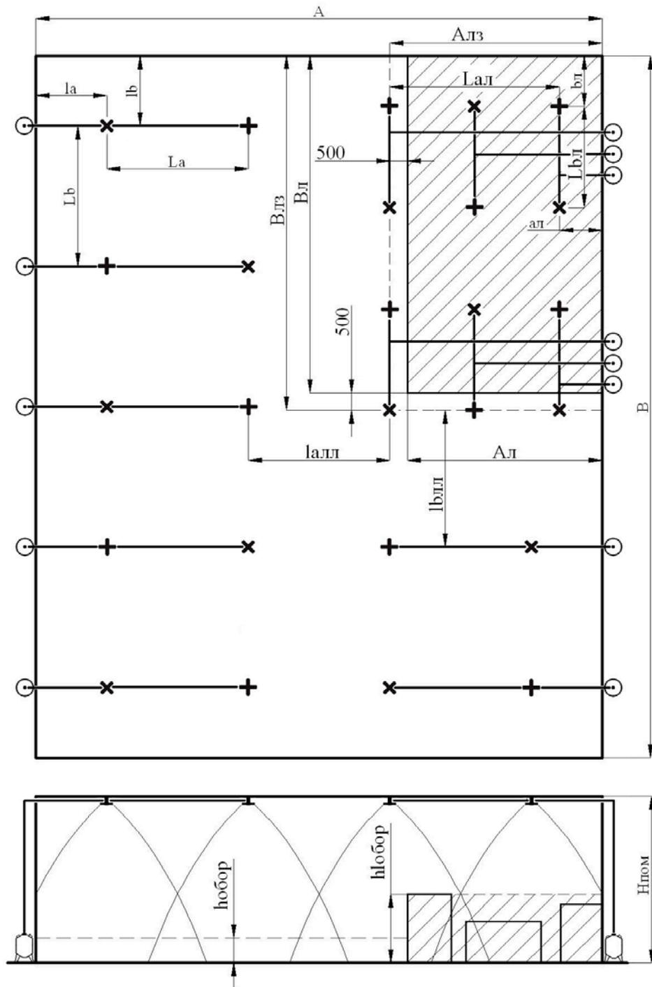
Защита помещений по всей площади с локальными зонами при групповом размещении модулей «ГАРАНТ-30» за пределами защищаемой зоны, включая помещения и зоны пожаровзрывоопасной категории
