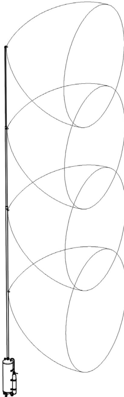
**Рис.И.13.**Схема подачи ТРВ под углом  $90^0$  для орошения вертикальных поверхностей при вертикальном размещении трубопровода из насадков НС-390-С или НС-360. Максимальная протяженность подводящего трубопровода (вертикальная часть) составляет : для ТРВ-Гарант-160-10 не более 8м., ТРВ-Гарант-160-40 не более 12 метров.
