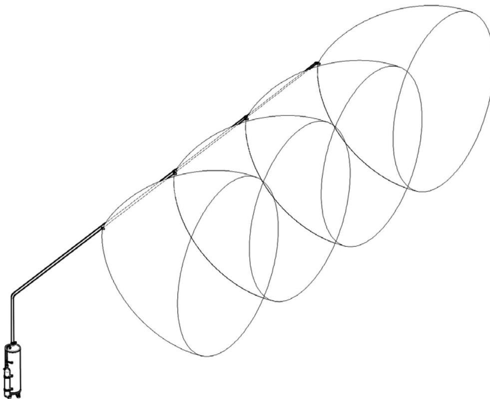
**Рис.И.12.**Схема подачи ТРВ под углом  $90^0$  для орошения вертикальных поверхностей при горизонтальном размещении трубопровода из насадков НС-390-С или НС-360. Максимальная протяженность подводящего трубопровода составляет : для ТРВ-Гарант-160-10 не более 25м., включая вертикальную часть не более 8 м., ТРВ-Гарант-160-40 не более 70 метров, включая вертикальную часть не более 12 метров.
