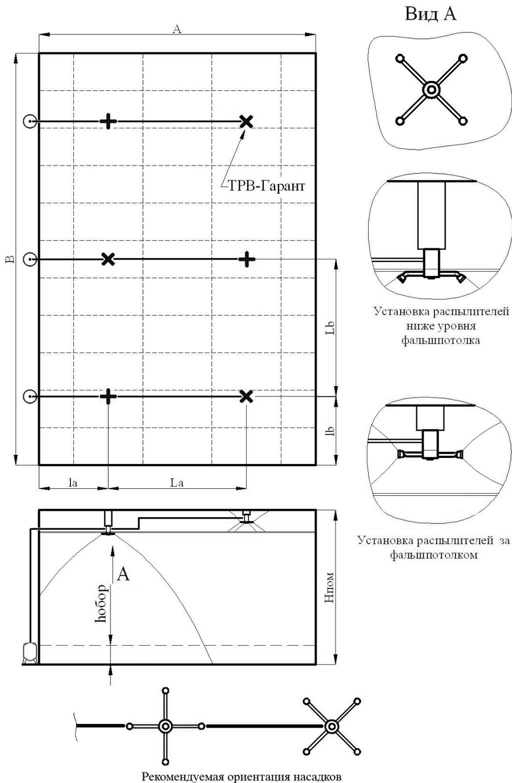
Защита помещений с фальшпотолками или фальшполами при использовании распылителей типа ТРВ-180 для защиты пространства за фальшпотолком и ТРВ-85 при его установке ниже уровня фальшпотолка.
