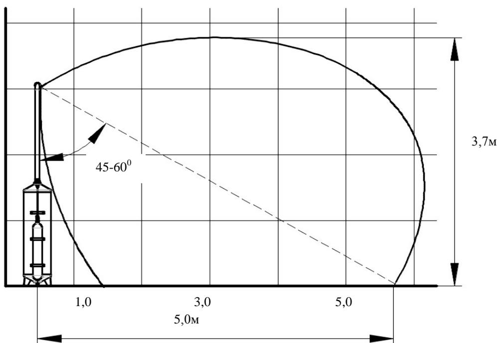
Рис.6.7. Диаграмма распыла насадка распылителя НС-390-С и НС-360 при подаче в интервале углов  $45-60^{\circ}$  к горизонтальной поверхности. Для НС-145 принимать согласно рис.М.1, М.2 Приложения М.
