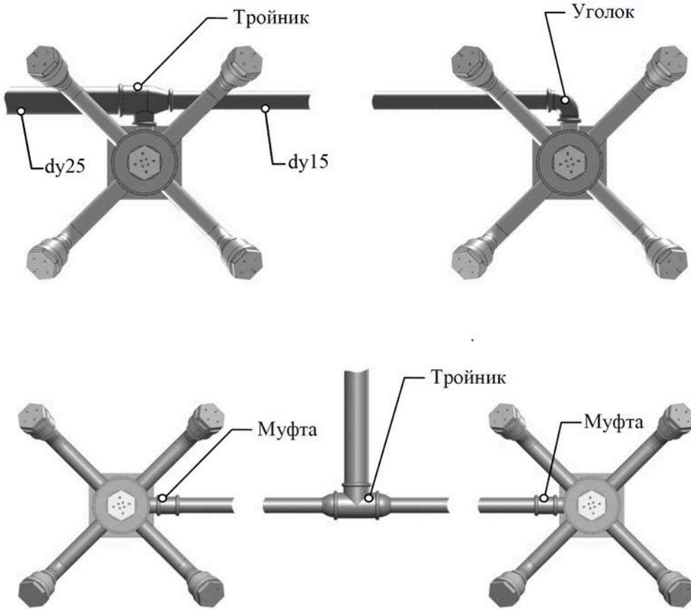
Рисунок Е.1. Схема установки МУПТВ «ТРВ-ГАРАНТ-30»
