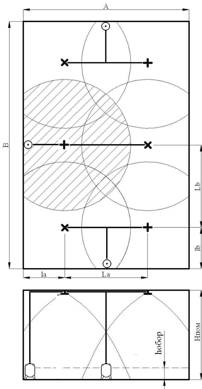
Защита небольших помещений по всей площади без локальных зон модулями ГАРАНТ-30(рекомендуемая схема размещения модулей внутри защищаемого помещения. Возможны любые другие схемы размещения модулей ГАРАНТ-30, обеспечивающие распределение распылителей по площади.
