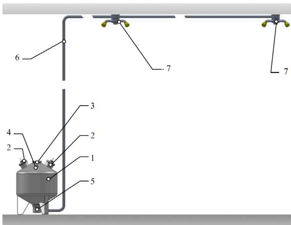
1. Корпус модуля (ёмкость для 30л запаса ОТВ)
