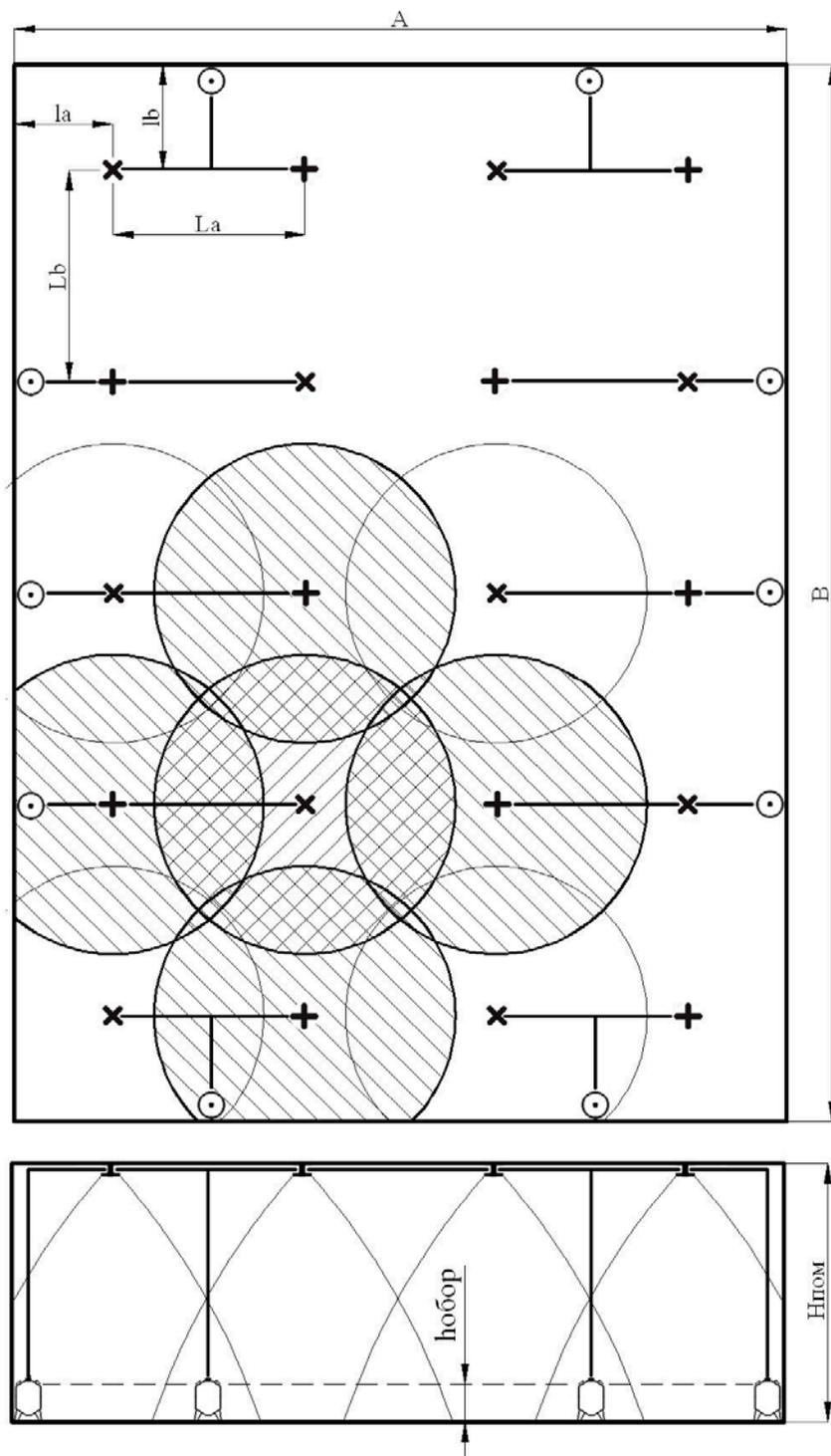
Защита помещений по всей площади без локальных зон при размещении модулей внутри помещений. Возможны любые другие схемы размещения модулей «ГАРАНТ-30», обеспечивающие представленное распределение распылителей по площади.
