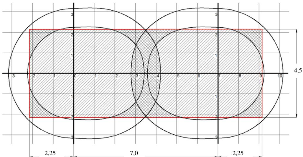
Рис.6.6. Диаграмма распыления двух взаимно-направленных насадков (НС-390-С) и площадь зоны тушения.
