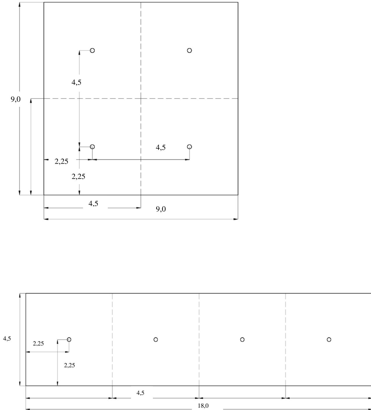
**Рис.И.7. Рекомендуемые схемы расположения распылителей НС-360 (симметричный распыл).**
