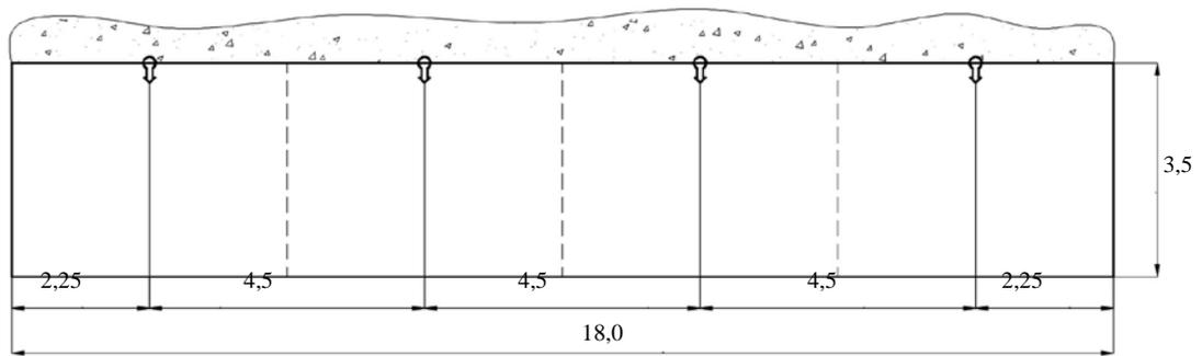
Рис.И.4. Конфигурации защищаемой площади при четырех одновременно работающих насадках НС-390-С.
