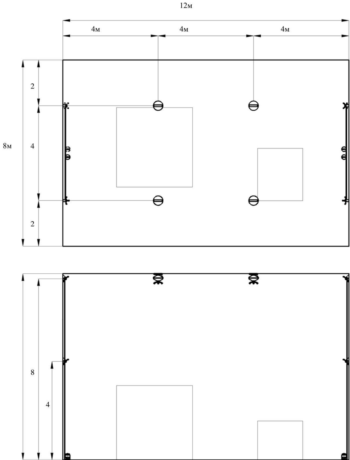
Защита с использованием комбинации модулей «ГАРАНТ-30» при их размещении ярусами и модулей ТРВ»ГАРАНТ-14,5»
