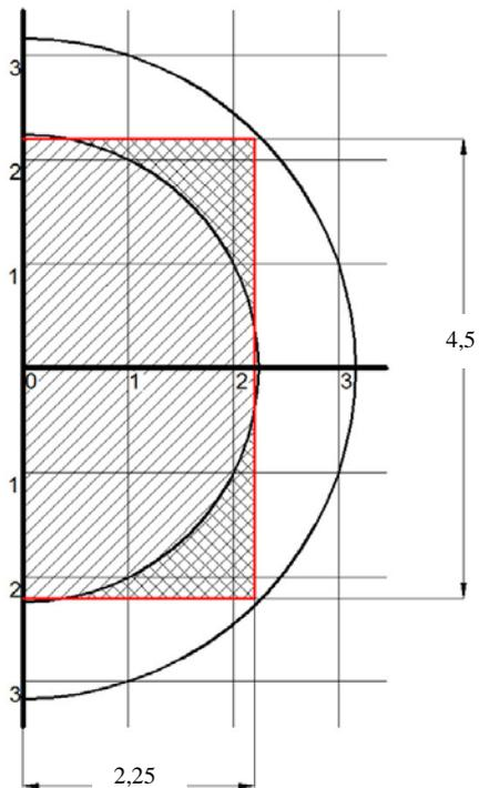
Рис. 6.3. Зона тушения НС-360(при расположении на вертикальной поверхности-стене).
